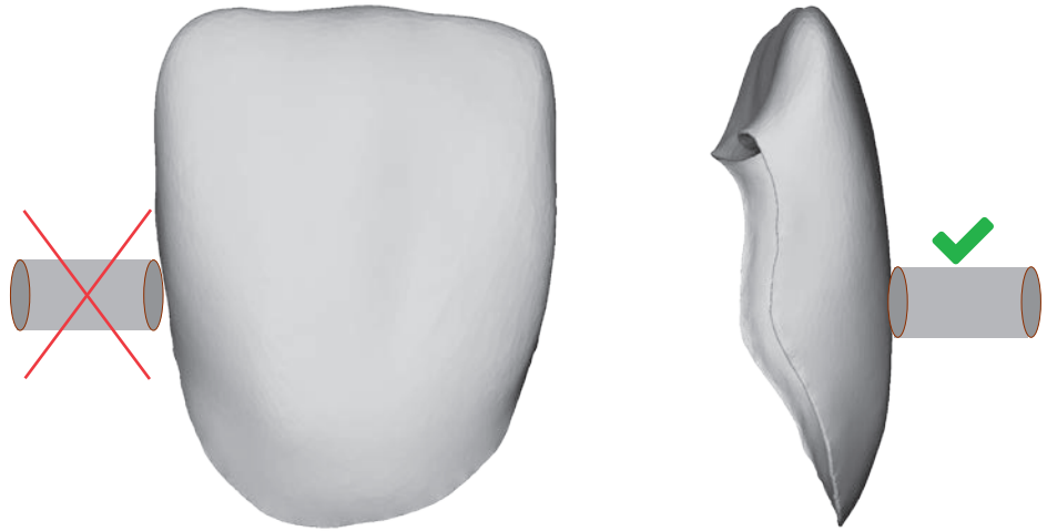
FIGURE 40: TRAVAIL DE TYPE „FACETTE“ AVEC DÉLIMITATION DES TIGES: LA TIGE DE GAUCHE EST MAL POSITIONNÉE ET CELLE DE DROITE EST CORRECTE
